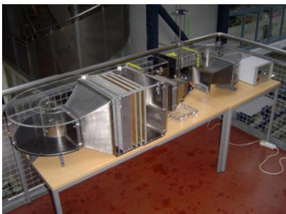
Bild: Das Modell des Modulares Windkanals „Göttinger Bauart“
