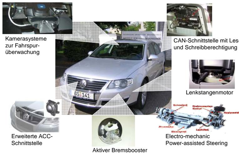
Experimentalfahrzeug und ausgewählte Zusatzeinbauten
